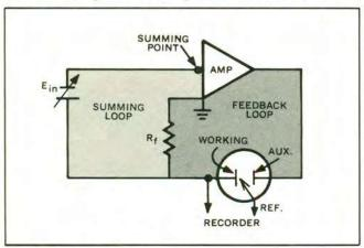
Figure 2. Galvanostat System.
