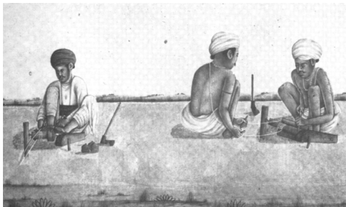
Figura 11. El torno de arco constituye un patrón clásico para convertir el movimiento lineal en rotatorio.
